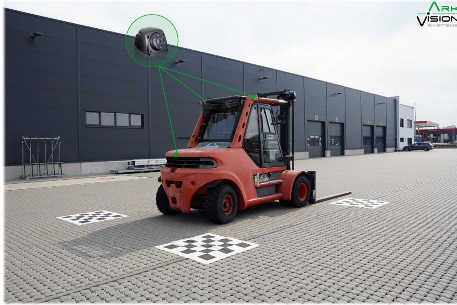
Mithilfe der Marker wird das System für den Einsatz kalibriert. Um das Fahrzeug herum wird ein Platzbedarf von mind. 1,2m benötigt. Dazu werden die vier Marker jeweils an den Fahrzeugkanten positioniert und das Bild aus der Steuereinheit exportiert. Durch das Kalibrierungstool kann das System innerhalb von wenigen Minuten kalibriert werden. Ein Ausmessen der Abstände und Fahrzeugmaße ist nicht notwendig. Diese ermittelt das System automatisch.
