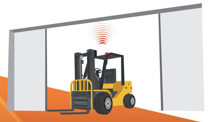
ESQOspeed Radar Ceiling Detection SpeedZoner Ce système permet aux chauffeurs de rouler vite à l'extérieur des bâtiments, tandis que leur vitesse est automatiquement réduite à l'intérieur. Le véhicule ralentit lui-même en cas de détection d'un toit, d'un auvent ou de tout autre obstacle dont la hauteur est inférieure à 24 mètres. Jusqu'à atteindre la vitesse que vous aurez vous-même configurée.
